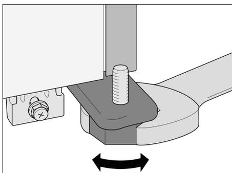
5. Поворачивая шестигранным ключом винты, выровняйте прибор сзади.
