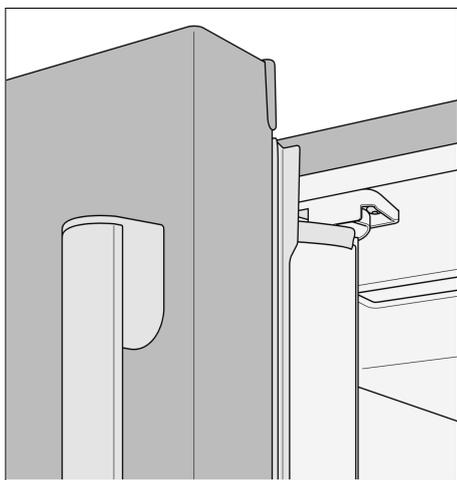
При закрытии левой дверцы защёлка заходит за правую дверцу и обеспечивает уплотнение между ними.
