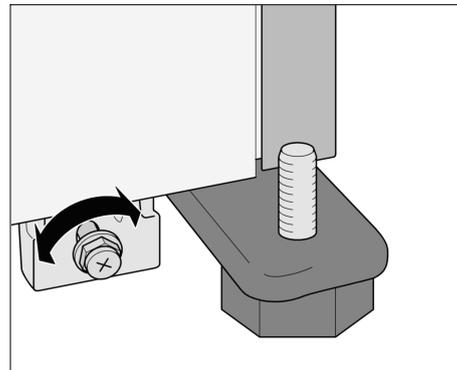
Опустить прибор сзади: поверните винт против часовой стрелки.
