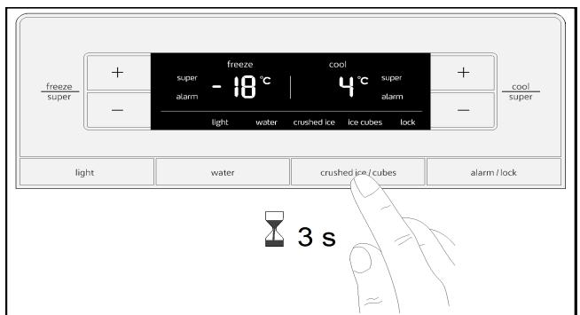
На дисплее в течение прим. 3 секунд мигают символы «Кубики льда», «Измельчённый лёд» и «Блокировка кнопок».
