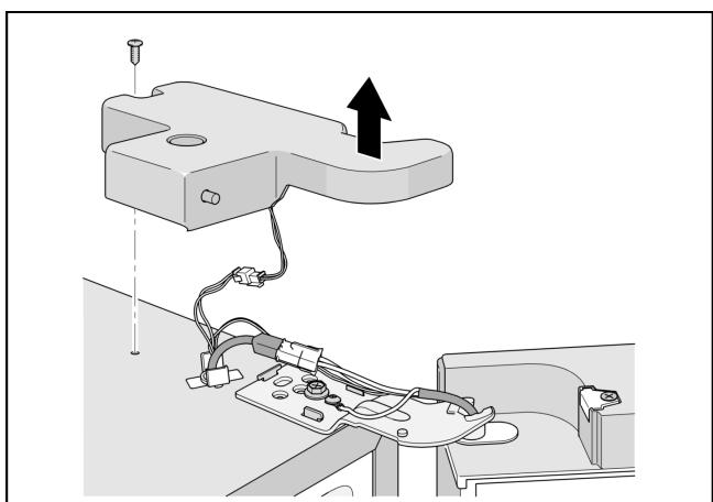
1. Выверните 2 винта и снимите крышку с верхней петли.
