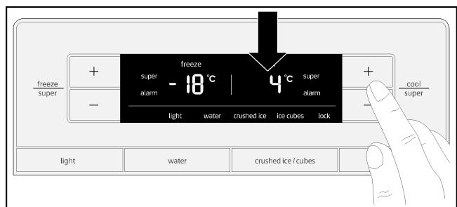
Последнее значение температуры сохраняется в памяти. Установленная температура отображается на дисплее холодильного отделения.
