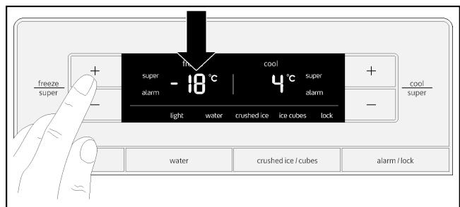
Последнее значение температуры сохраняется в памяти. Установленная температура отображается на дисплее морозильного отделения.
