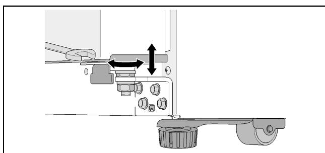
5. Если дверца морозильного отделения расположена ниже: Поворачивайте регулировочную гайку против часовой стрелки.
