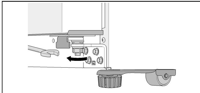
4. Поворачивайте регулировочную гайку до тех пор, пока дверцы прибора не будут установлены ровно.
