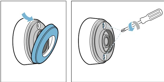
2. Откройте заглушку датчика температуры. Выньте батарейку из нижней части корпуса и установите новую батарейку (при этом следите за правильной установкой полюсных выводов батарейки).
