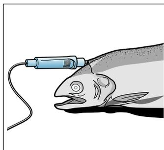
**Переворачивание продукта:** если вы хотите перевернуть продукт, не вынимайте термометр для жаркого. После переворачивания проверьте правильное положение термометра в продукте.
