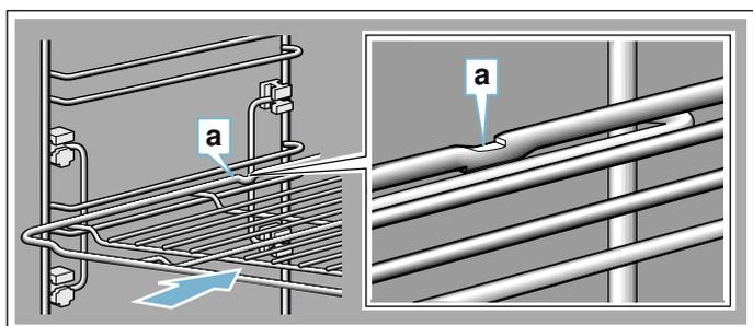
При установке противней следите за тем, чтобы фиксирующий выступ **a** находился сзади и был обращён вниз. Скошенный край противня **b** должен быть обращён вперёд к дверце прибора.
