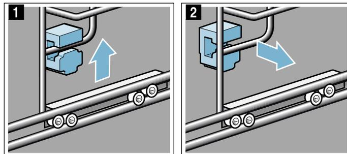
3. Затем поверните весь навесной элемент наружу **a** и выньте его заднюю часть **b** (рис. 3).
