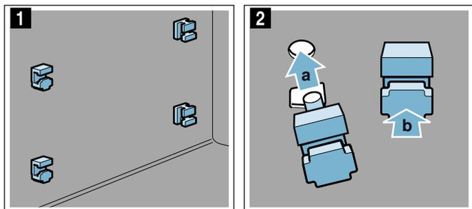
3. Установите крючок заднего держателя в верхнее отверстие **a** и вставьте держатель в нижнее отверстие **b** (рис. **3**).
