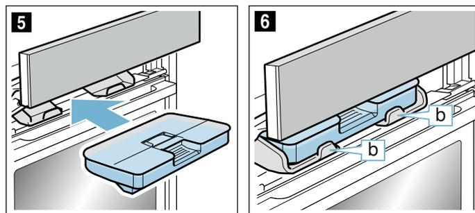
9. Медленно передвиньте панель вниз, затем отожмите её назад, пока она полностью не закроется. Резервуар наполнен. Теперь можно запустить режим с использованием пара.
