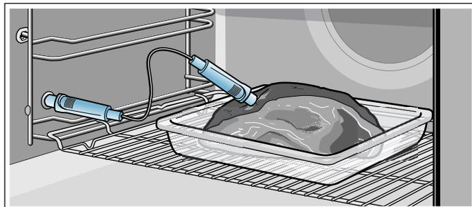
**Птица:** вставьте термометр через самую толстую часть грудки птицы до упора. В зависимости от свойств продукта располагайте термометр для жаркого вдоль или поперек. Переверните птицу и положите её на решётку грудкой вниз.
