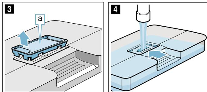
7. Снова вставьте крышку **a**, закрыв отверстие резервуара для воды.
